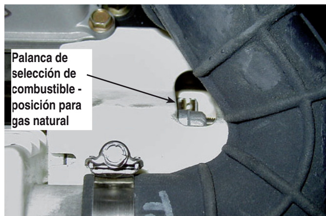
Figura 1.6 - 10kW, GT-530 (manguera de entrada deslizada atrás)
