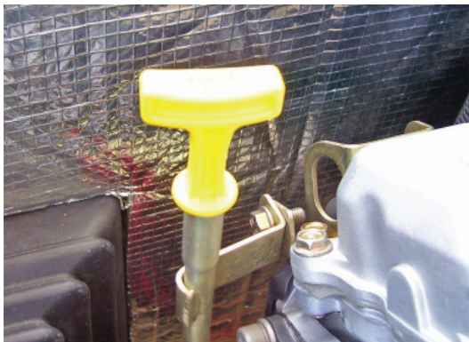
Schéma 4.3 — Jauge et remplissage d'huile, 12, 14, 16, 17 et 20 kW
