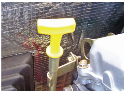
Figura 4.3 — Varilla de aceite y llenado, 12, 14, 16, 17 & 20kW
